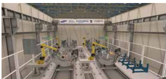
삼성엔지니어링 Piping &amp; 철골 용접 자동화
